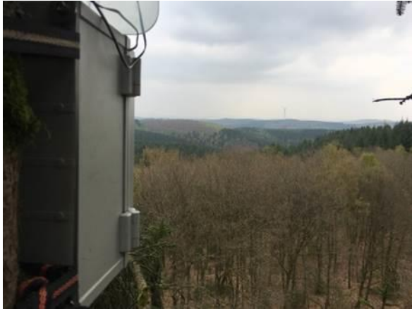
Abbildung 2: Wetterfeste Box mit einem batcorder zur akustischen Erfassung der Fledermausaktivität über den Baumkronen im Planraum „Freudenberg“.
