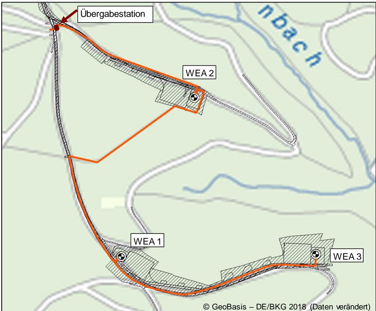
Abbildung 2: Übersicht des geplanten Kabelverlaufs (orange) und der Übergabestation (dunkelrot)
