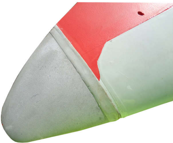
Abb. 6 - 1: Rezeptor an einer Rotorblattspitze
