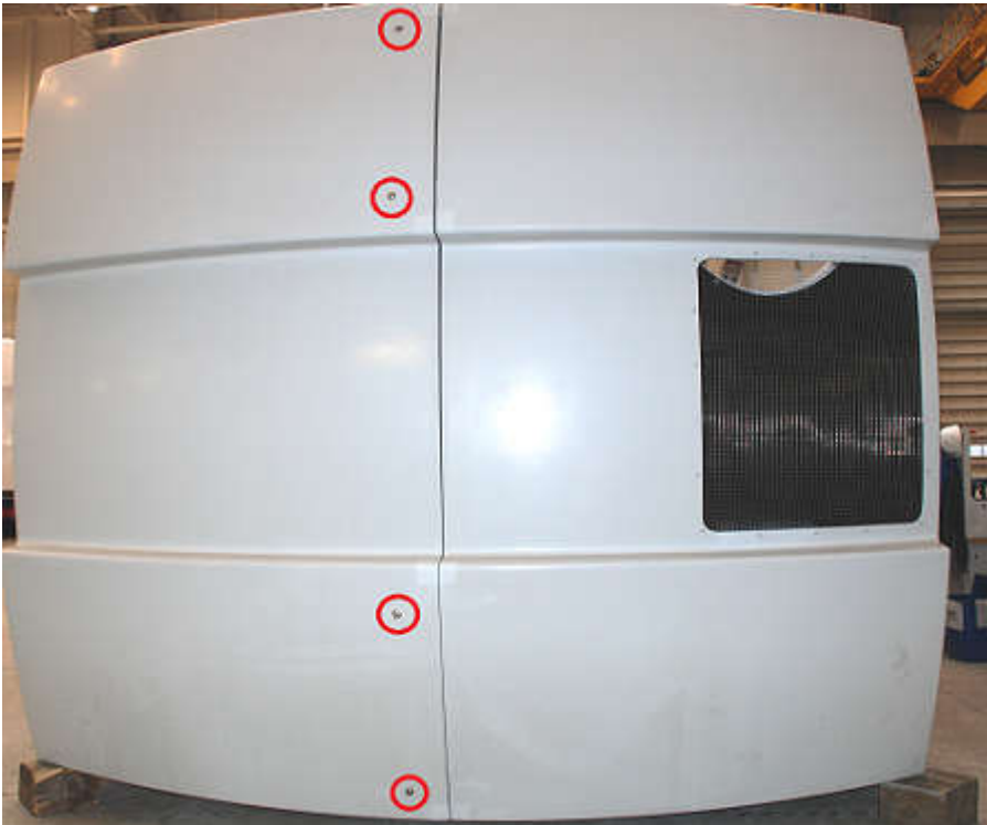
Abb. 8 - 1: Rezeptoren an der Gondel der Baureihe 3.XM EBC
