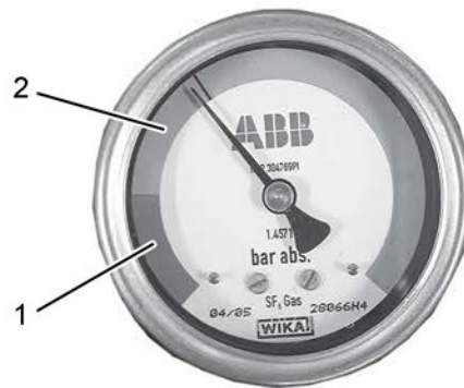
Abb. 2: Gasdruckanzeige an SafeRing- / SafePlus-Schaltanlagen
