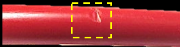
Beschädigungen durch Abrieb
