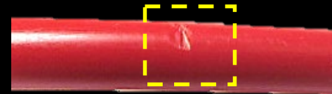
Beschädigungen durch Abrieb
