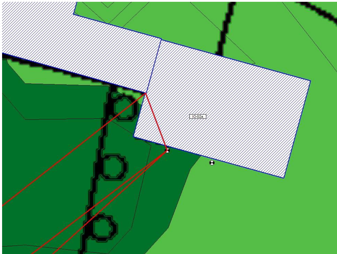
Abbildung 2: Darstellung der Schallstrahlen von den zwei am Standort geplanten WEA der Zusatzbelastung zum meistbelasteten Fenster am IO-02
