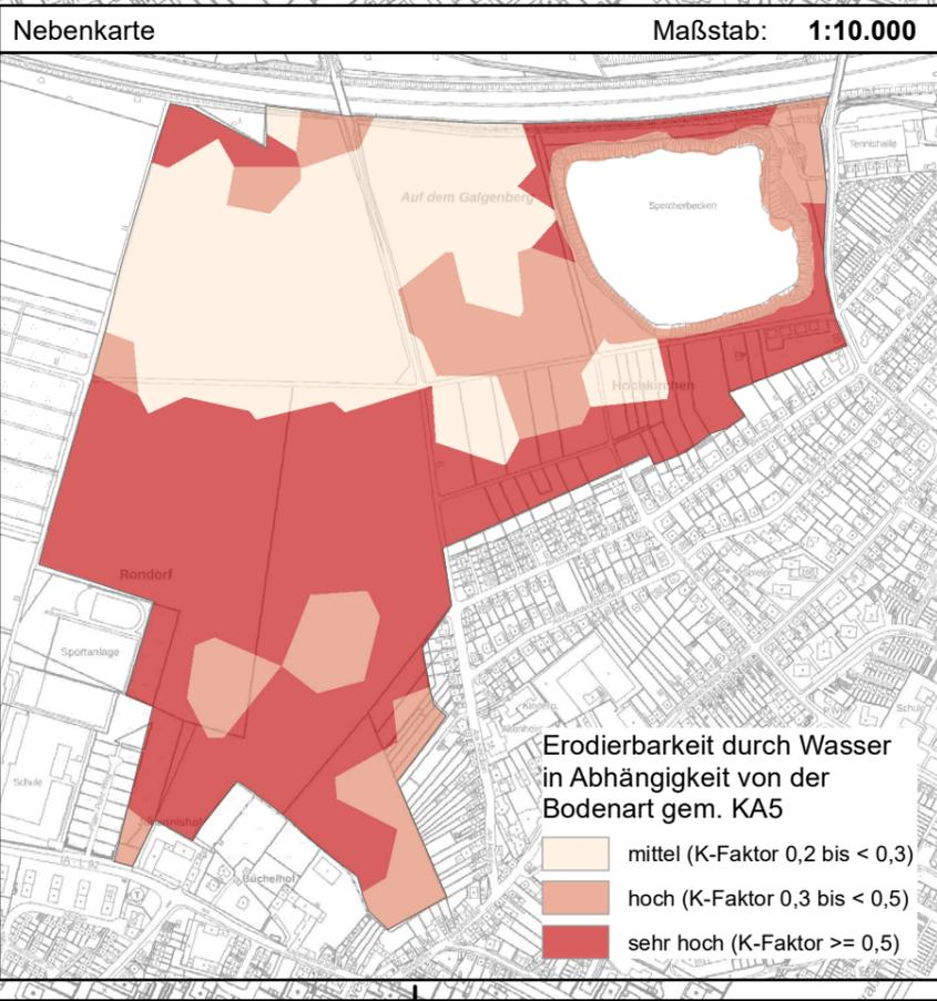
**Darstellung der Oberflächenmorphologie (Hangneigung) und der bodenartspezifischen Erodierbarkeit (K-Faktor) als Einflussgrößen auf die natürliche Erosionsgefährdung**
