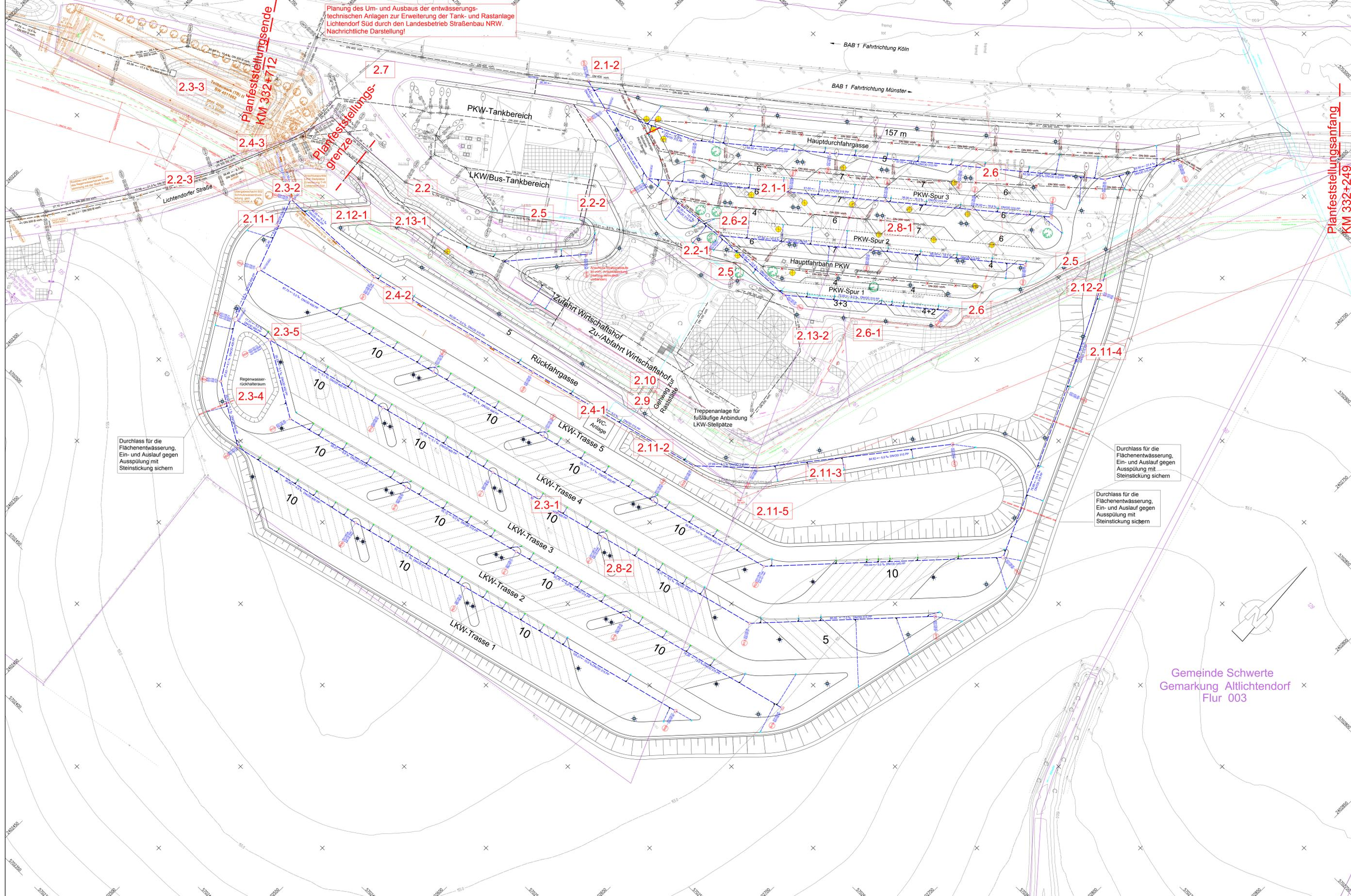
Planung des Um- und Ausbaus der entwässerungstechnischen Anlagen zur Erweiterung der Tank- und Rastanlage Lichtendorf Süd durch den Landesbetrieb Straßenbau NRW. Nachrichtliche Darstellung!
