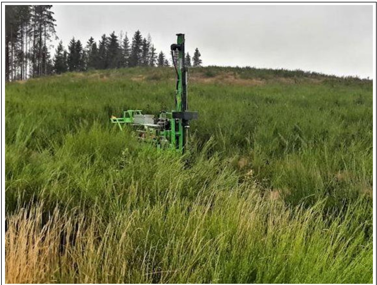
Abbildung 4.1: Baugrunderkundung im Windpark Sundern II
