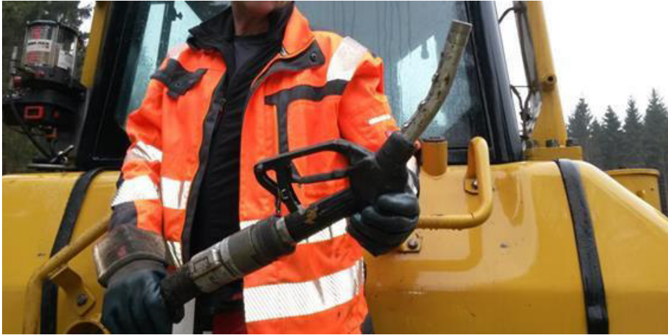
Abbildung 3: Empfohlene Maßnahme: Betankung von Baugerät mit rückschlaggesicherter Zapfpistole
