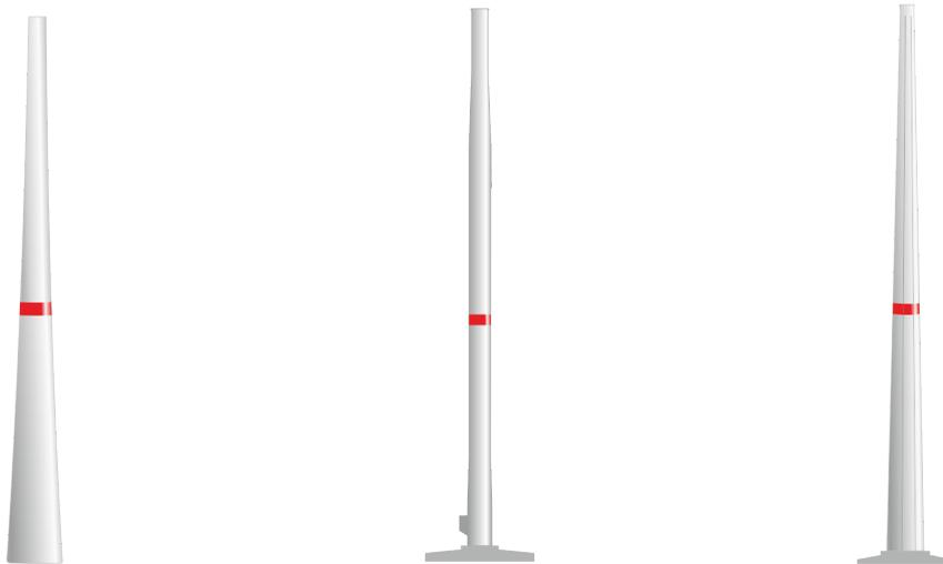
**Abb. 5: Farbliche Kennzeichnung am Turm, beispielhafte Darstellung**
