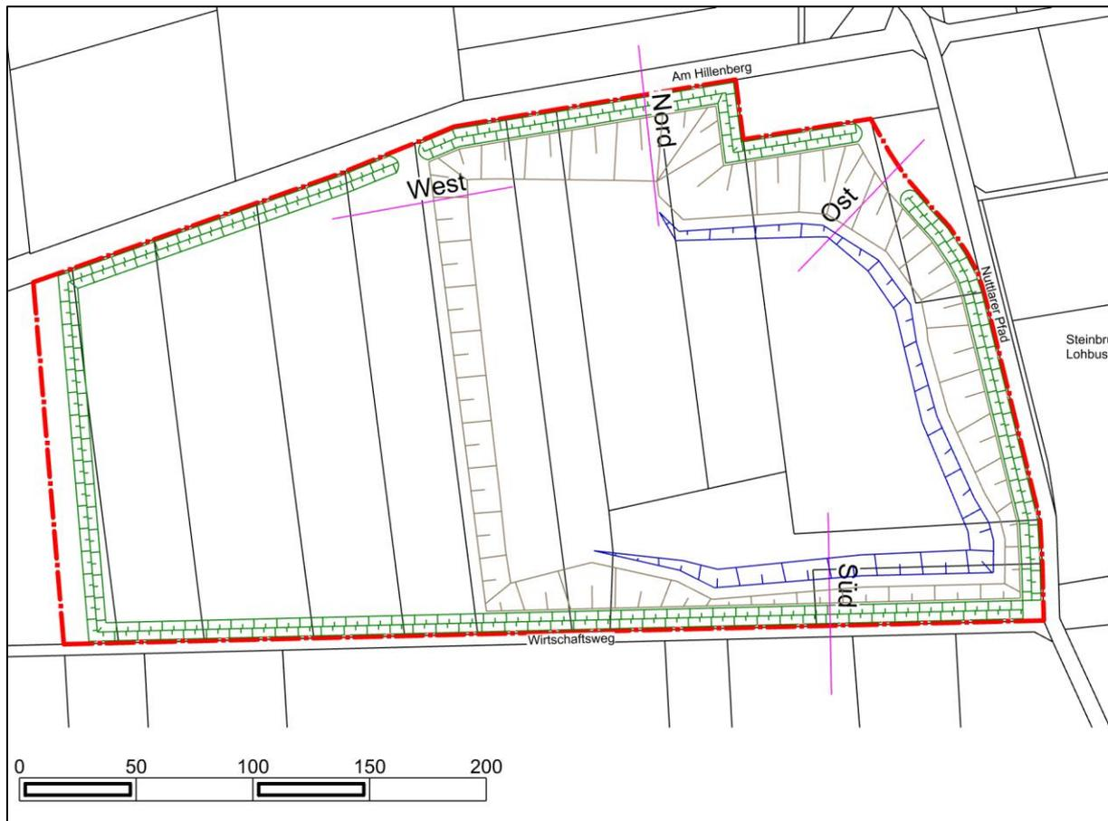
**Abb. 5: Lage der Profilschnitte der berechneten Abraumböschungen**
