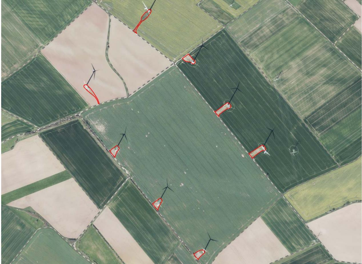
*Abb. 4: Rückbau der Altanlagen 9-16: Die rot markierten Bereiche (Zuwegung, Kranstellflächen und Fundamente der Altanlagen 9-16) werden vollständig rekultiviert*
