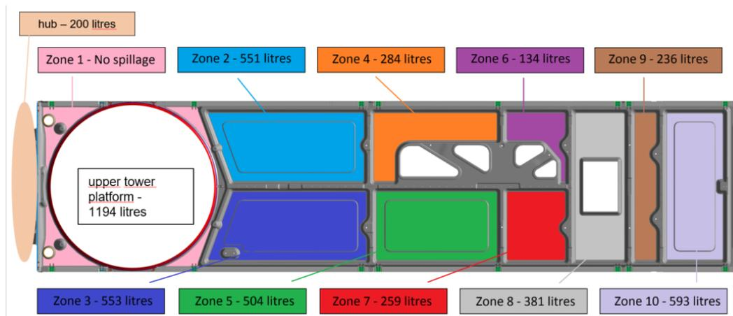
Abbildung 1: Auffangvolumina der jeweiligen Schutzzone der EnVentus
