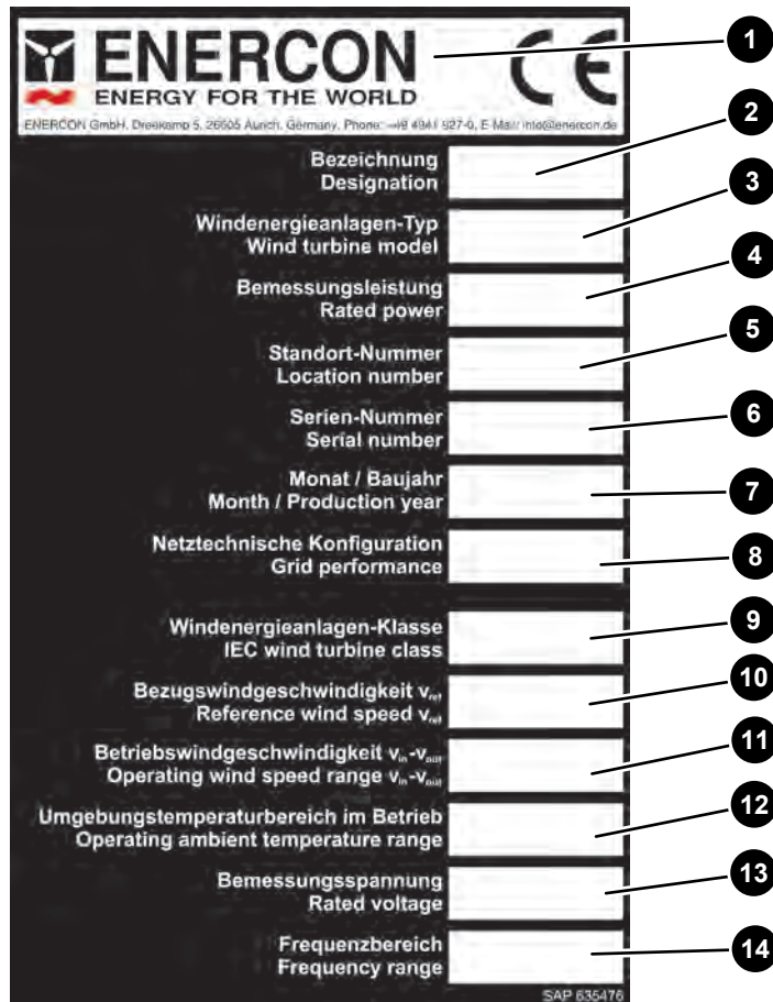
Abb. 66: Muster des Typenschilds der Windenergieanlage
