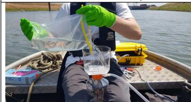
Abb. 15: Überführung der Wasserprobe in das Filtrationssystem.
