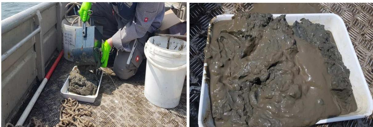
Abb. 4 und 5: Bodengreifer mit Sedimentinhalt (l.) und überführtes Sediment in eine Weißschale (r.).
