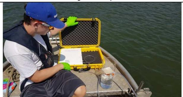
Abb. 16: Vakuumpumpe und Filtrationsgefäß.
