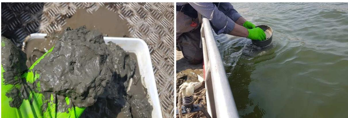
Abbildung 7 und 8: Überführung der Sedimente und haptische Kontrolle (l.) und Siebung der Sedimente (r.).
