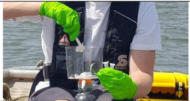
Abb. 18: Entnahme des Filters und Überführung in das Transportgefäß.
