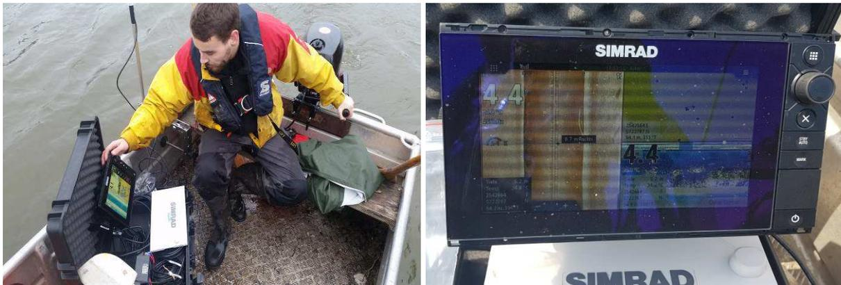
Abbildung 11 und 12: Echolotinstallation mit Signalgeber (l.) und Anzeigedisplay mit Darstellung des Bodengrundes im Betrachtungsbereich I (links) und Bodenmorphologie im Betrachtungsbereich I (rechts unten) (r.).
