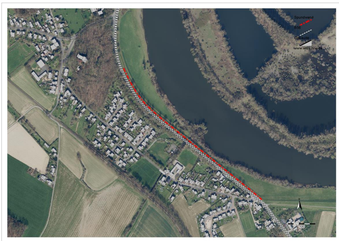
Bild 2: Verlauf der Spundwand (rot)
