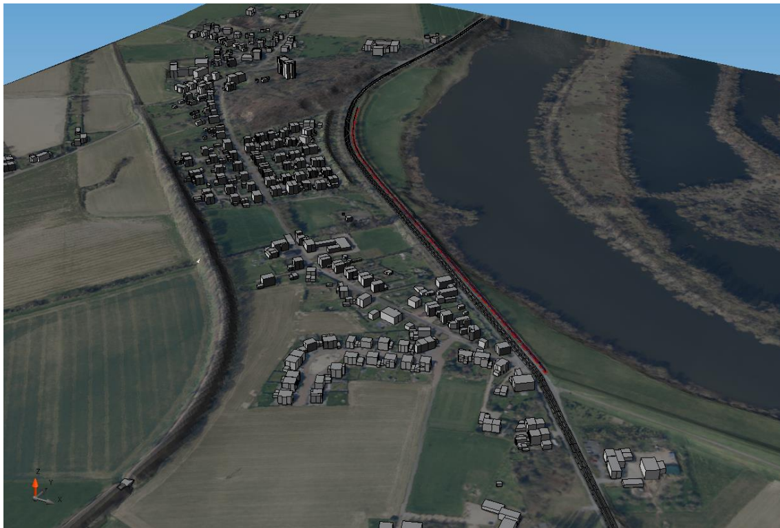
Bild 1: Gelände- Gebäudemodell, rot verlauf der Spundwand
