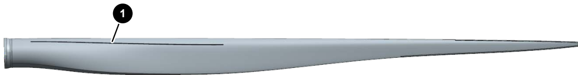
Abb. 7: Position der Vortexgeneratoren an der Saugseite
