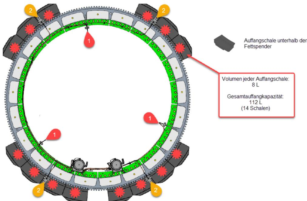
Abbildung 3: Auffangschalen am Azimutgetriebe
