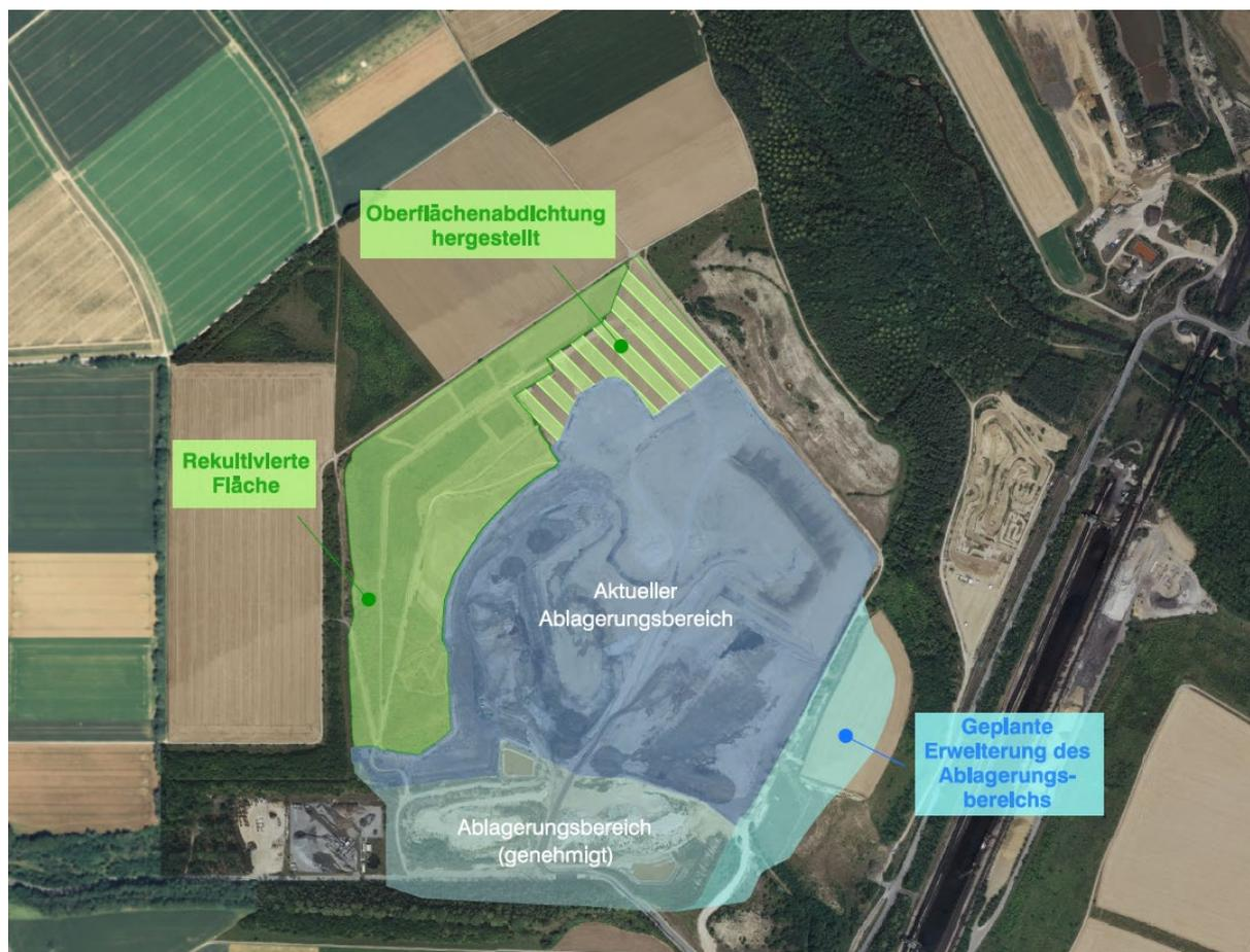
**Abbildung 2: Ist-Stand Ablagerungsbereich mit geplanter Erweiterung des Ablagerungsbereichs (Beflegungsdatum 03.08.2020 © RWE Power)**
