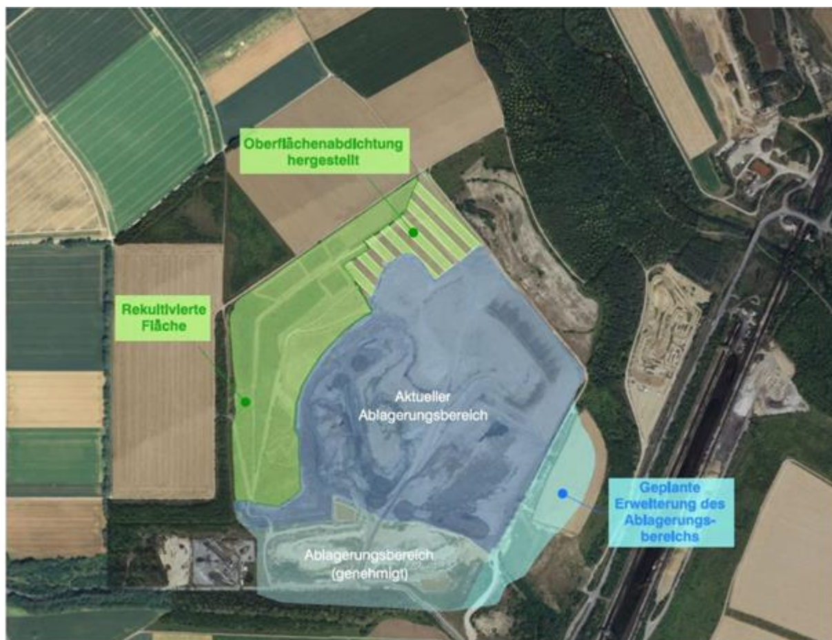
Abbildung: Ist-Stand Ablagerungsbereich mit geplanter Erweiterung des Ablagerungsbereichs (Befliegungsdatum 03.08.2020 © RWE Power)
