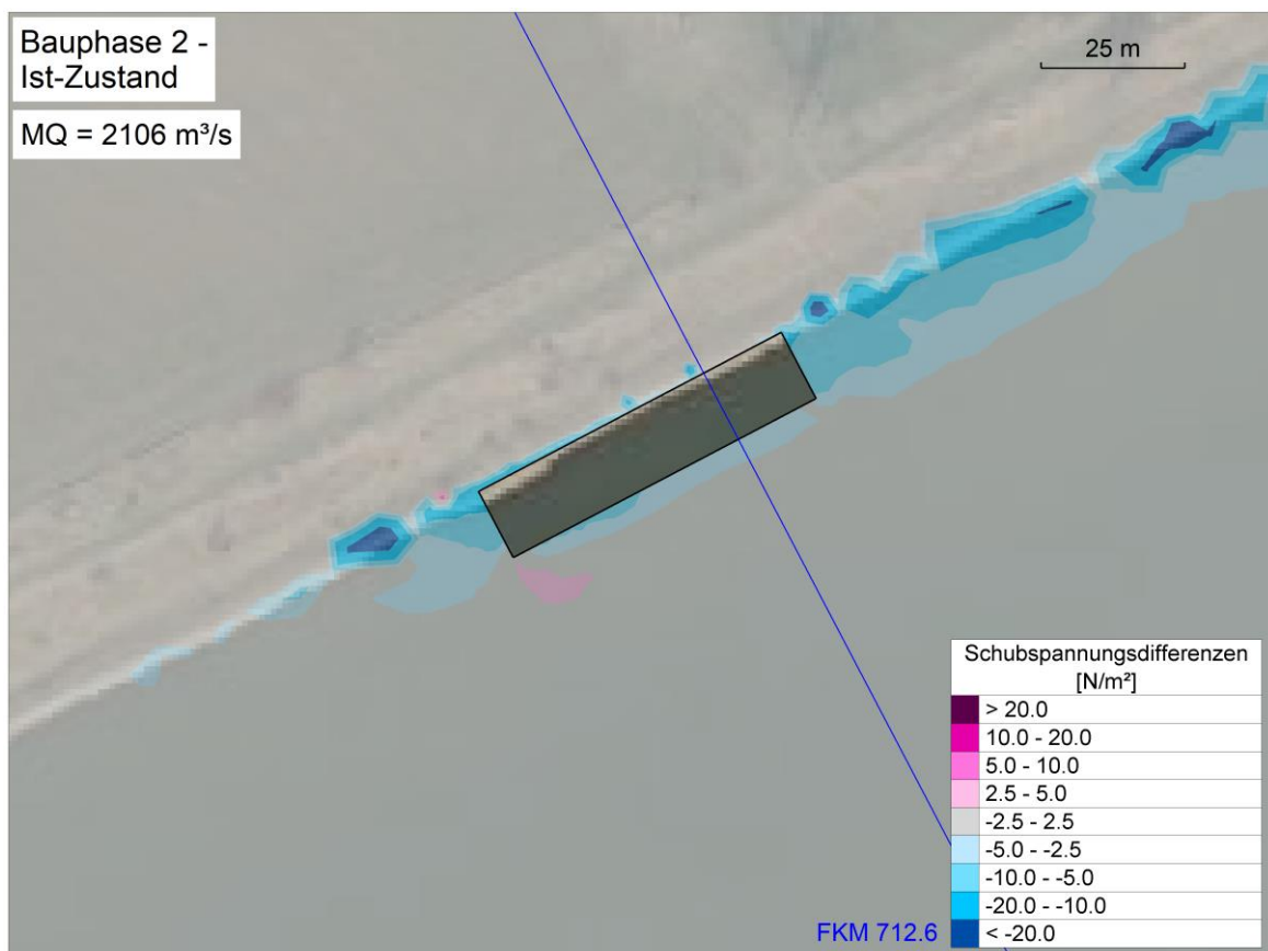
Abbildung 115: Schubspannungsdifferenzen, Bauphase 2 - Ist-Zustand, MQ
