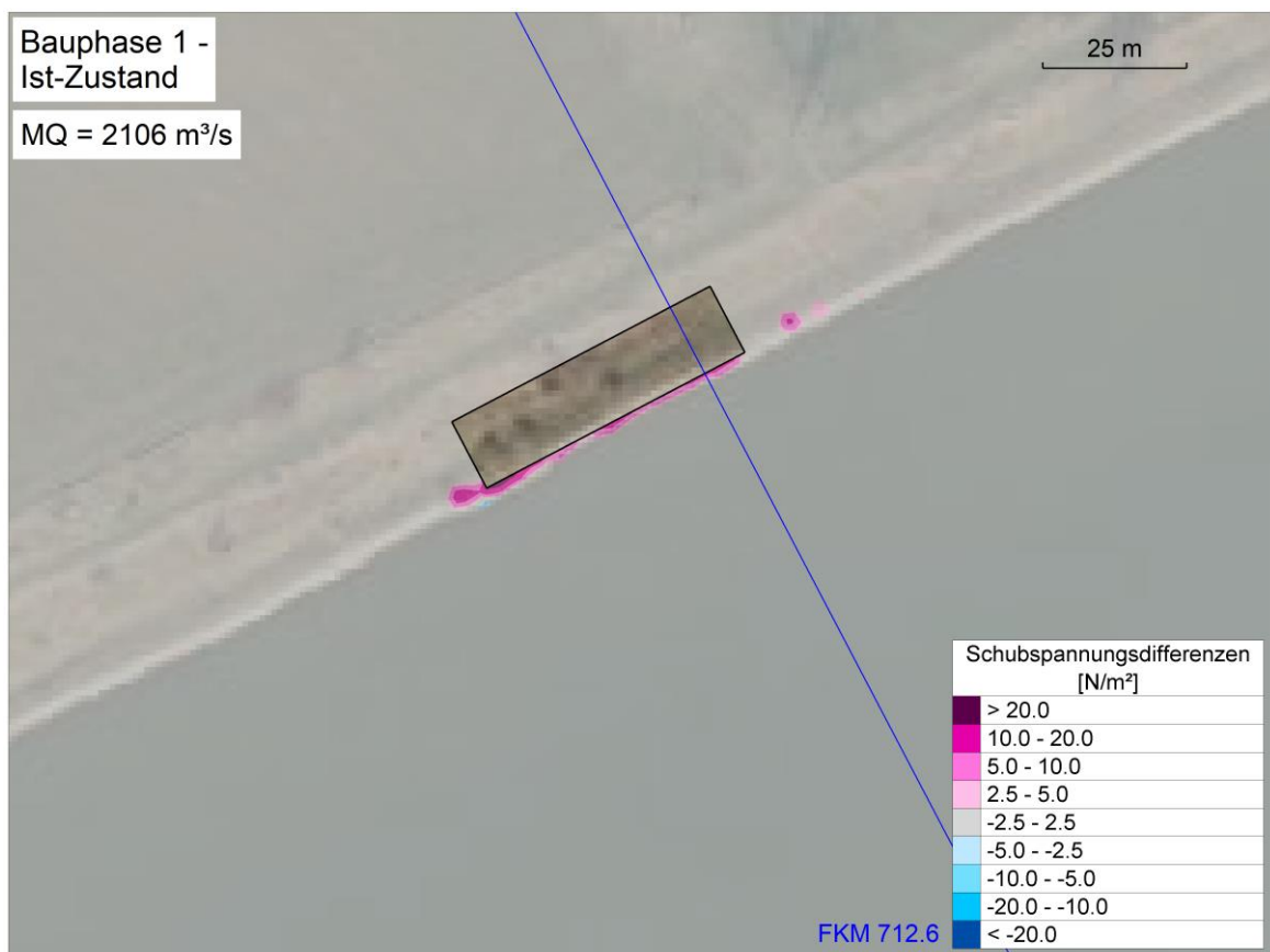
Abbildung 113: Schubspannungsdifferenzen, Bauphase 1 - Ist-Zustand, MQ
