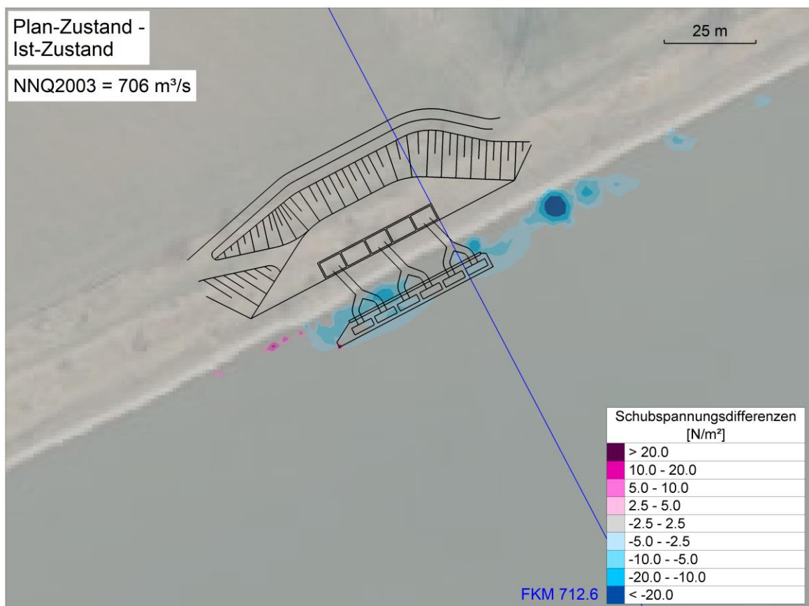
Abbildung 110: Schubspannungsdifferenzen, Plan-Zustand - Ist-Zustand, NNQ2003
