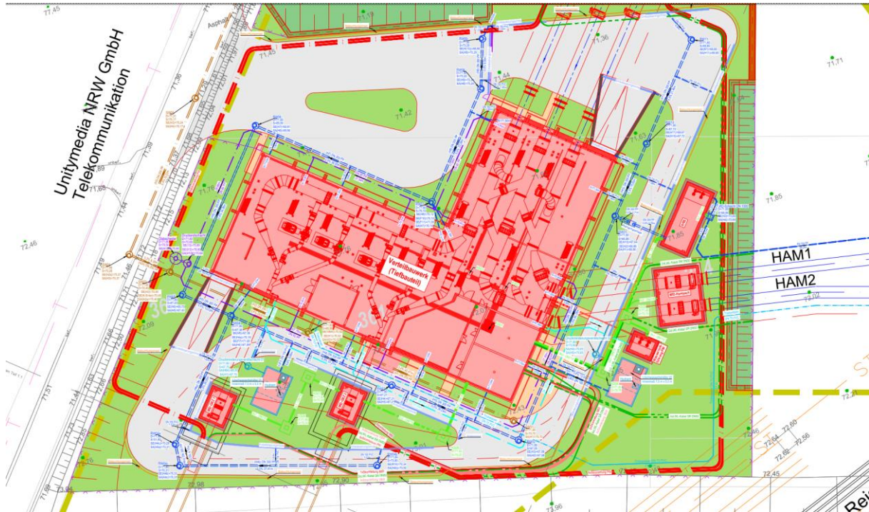
Abbildung 3: Verlaufsplan des Niederschlagwasserkanals (in schwarz)
