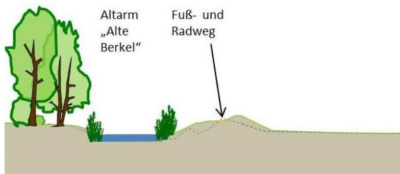
Abbildung 4-4: Umwidmung der Berkel unterhalb des Wehres Blomenesch zu einem Altarm und Erhöhung des bestehenden Dammes
