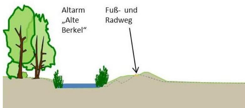
Abbildung 4-4: Umwidmung der Berkel unterhalb des Wehres Blomenesch zu einem Altarm und Erhöhung des bestehenden Dammes
