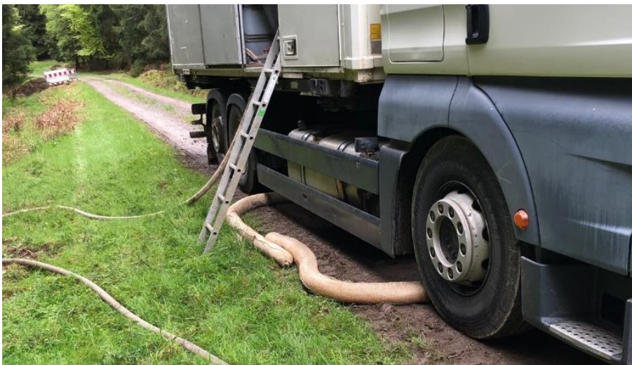
Abbildung 8: Empfohlene Maßnahme: Vorsorgliche Auslage von Sorbschlängeln unter Tanks, z.B. von Kranwagen
