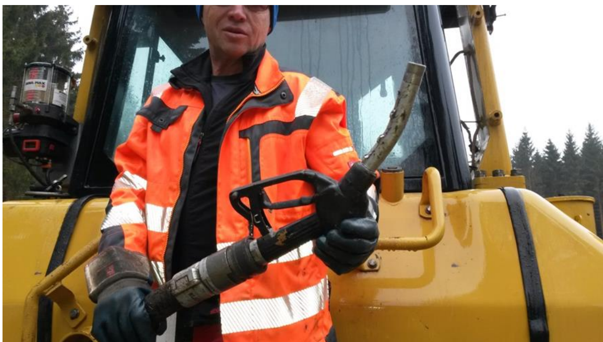
Abbildung 6: Empfohlene Maßnahme: Betankung von Baugerät mit rückschlaggesicherter Zapfpistole
