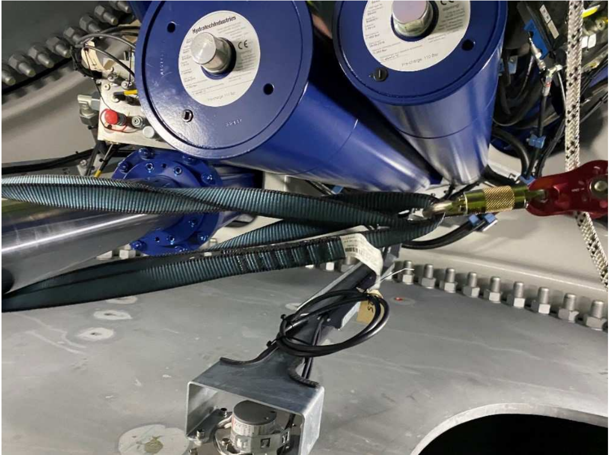
Abbildung 7.28: Das Seil wird durch eine Rolle geführt, die an einem Pitchzylinder aufgehängt ist.
