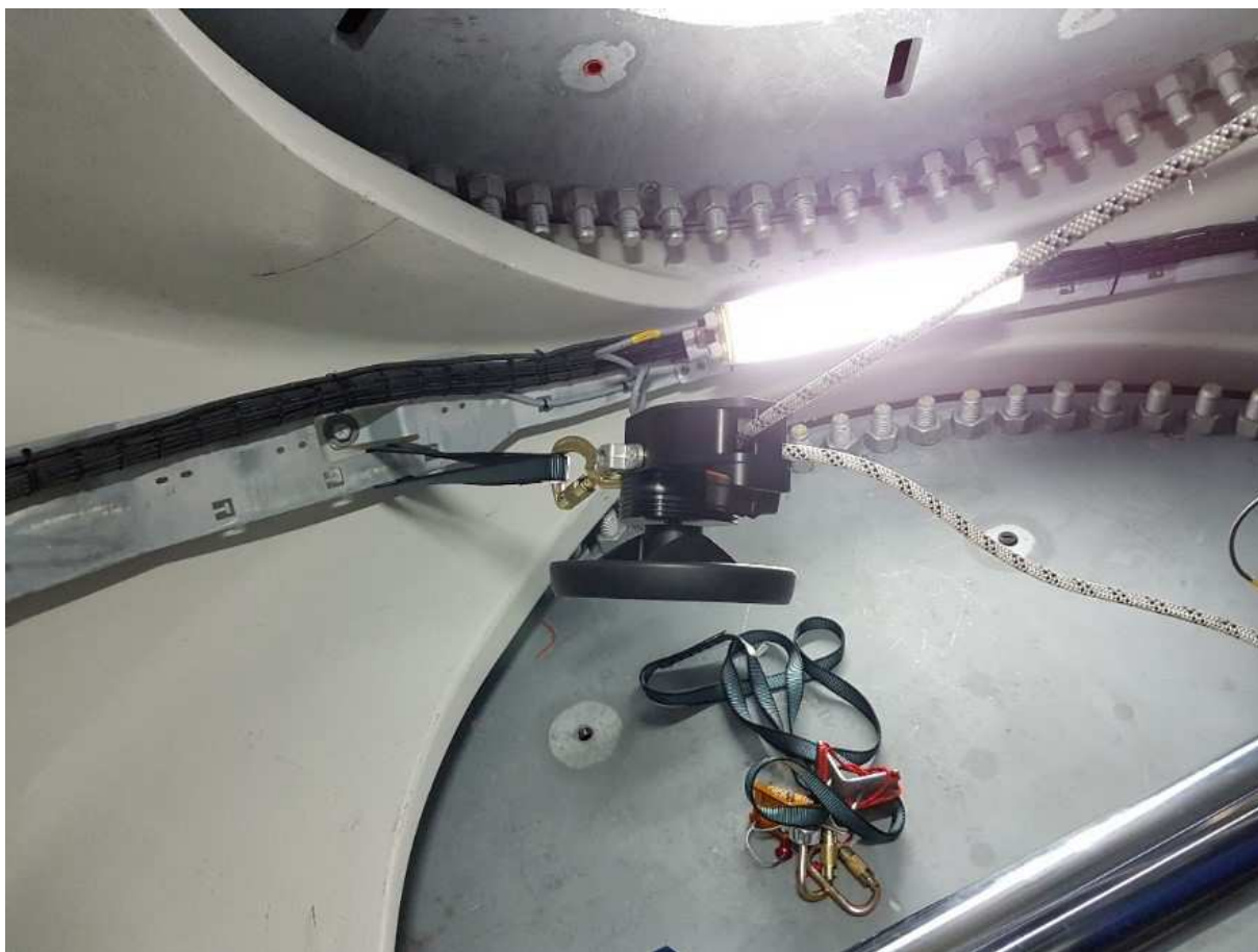
Abbildung 7.25: Befestigung des Rettungsgeräts an der Nabenhalterung
