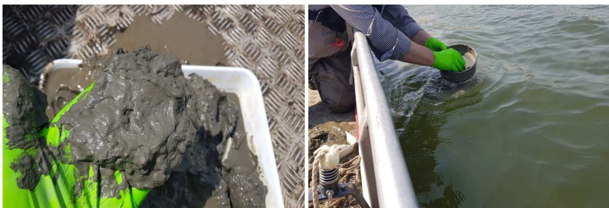
Abbildung 7 und 8: Überführung der Sedimente und haptische Kontrolle (l.) und Siebung der Sedimente (r.).
