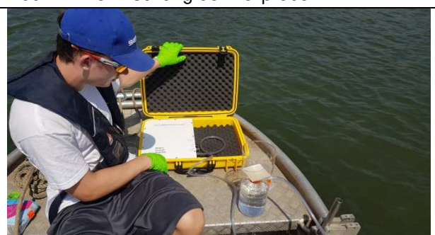
Abb. 16: Vakuumpumpe und Filtrationsgefäß.
