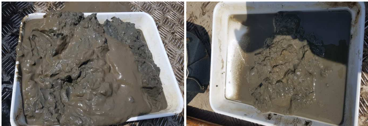
Abbildung 22 und 23: Sedimente aus dem Betrachtungsbereich I mit anoxischen (schwarz gefärbten) Bereichen (l.) und schlammig-sandige Sedimente nahe der Hafeneinfahrt (r.).
