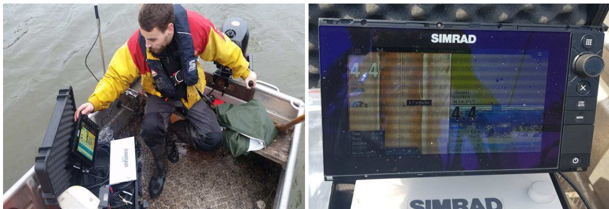
Abbildung 11 und 12: Echolotinstallation mit Signalgeber (l.) und Anzeigedisplay mit Darstellung des Bodengrundes im Betrachtungsbereich I (links) und Bodenmorphologie im Betrachtungsbereich I (rechts unten) (r.).
