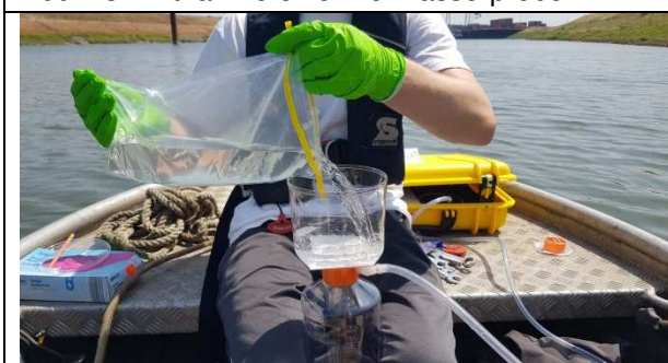
Abb. 15: Überführung der Wasserprobe in das Filtrationssystem.
