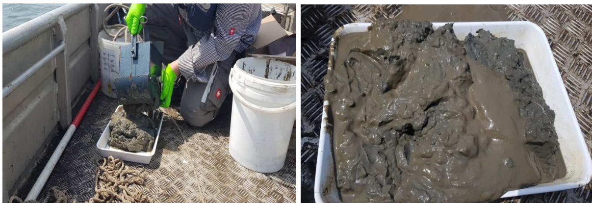
Abb. 4 und 5: Bodengreifer mit Sedimentinhalt (l.) und überführtes Sediment in eine Weißschale (r.).
