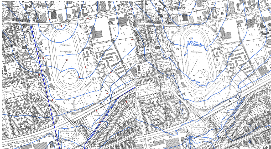
Abbildung 26: Vergleich der Grundwassergleichen Ist-Zustand (rechts) und Planungszustand (links)
