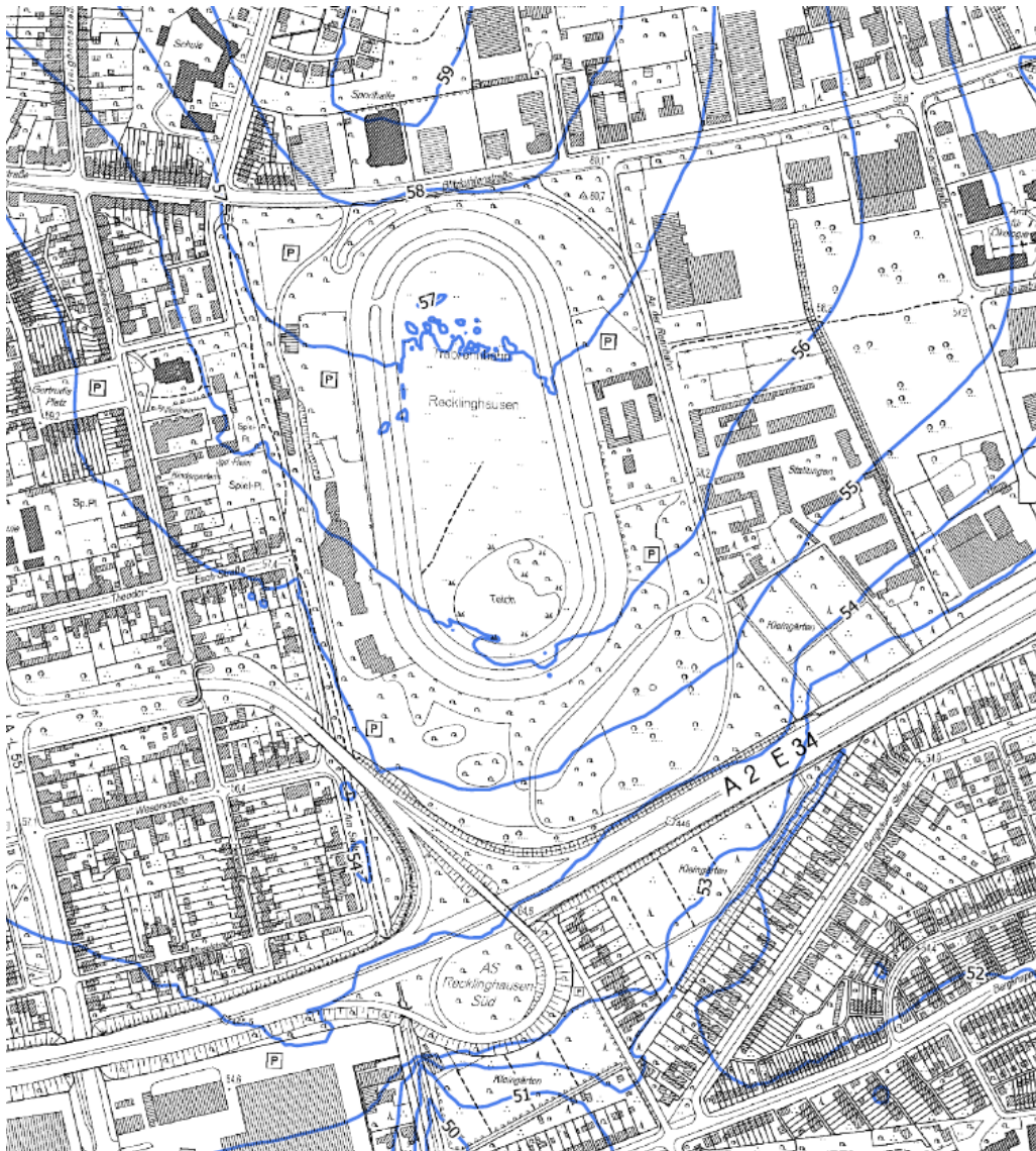
Abbildung 10: Berechnete Grundwassergleichen für den Planzustand
