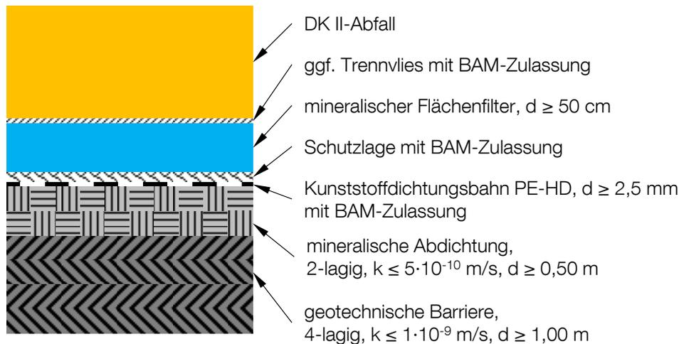
**Abbildung 6-6: Aufbau Basisabdichtungssystem DK II**
