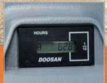
Betriebsstundenzähler (vom Boden aus ablesbar)
