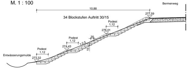
**Längsschnitt Treppe bei Station ~ 0+048**
