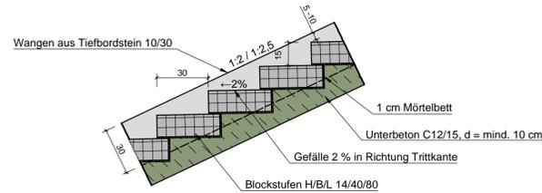
**Längsschnitt Treppe bei Station ~ 0+057**
