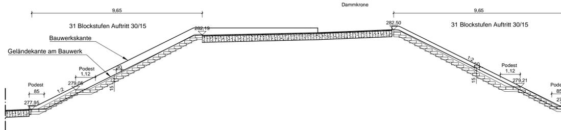
**Längsschnitt Treppe bei Station ~ 0+070**
