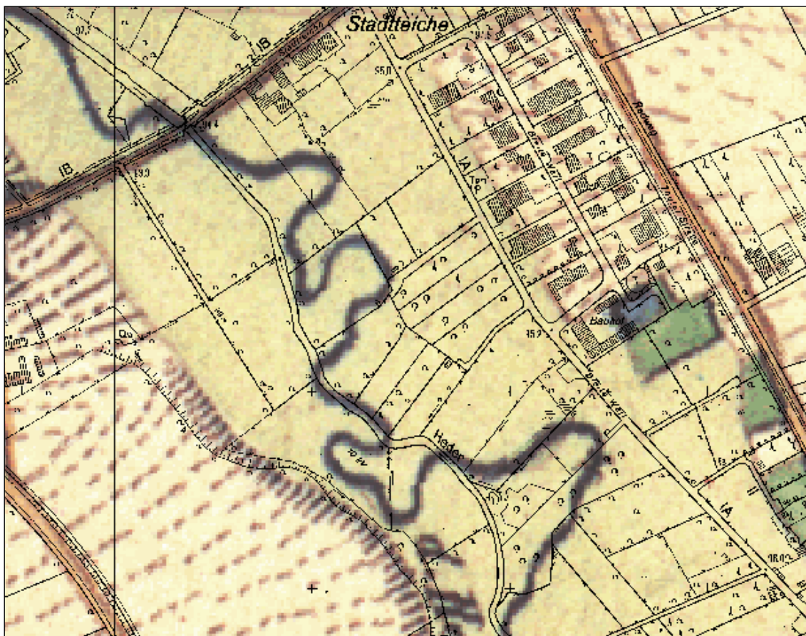
Abb. 3-1: Überlagerung des historischen Verlaufs der Heder um 1836 (blaue Linie, preußische Uraufnahme) mit dem aktuellen Verlauf des Flusses
