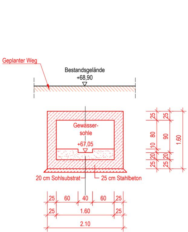
Längsschnitt durch Kastenprofil
