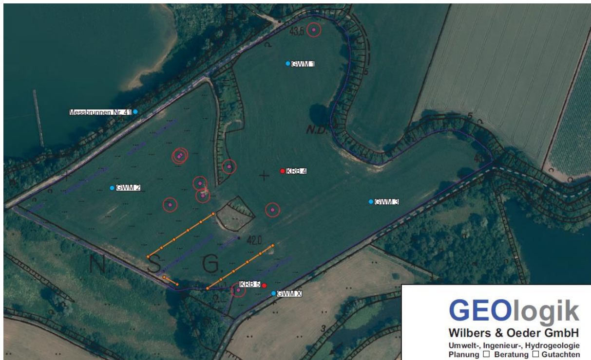
Positionierung eingerichteter Grundwassermessstellen im zukünftigen Abgrabungsbereich
