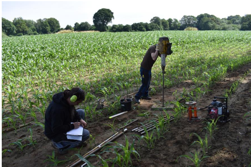
Abbildung 5 Einschlagen des Hohlzylinders mit Hilfe eines benzinbetriebenen Bohrhammers (Hintergrund) und Aufnahme und Probennahme der gewonnenen Keren (Vordergrund).
