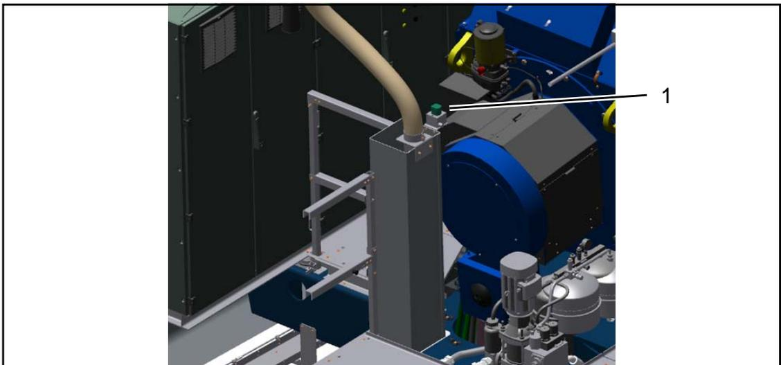
Abb. 22: Ausschalter Mittelspannung (1) am Kettenkasten Elektrokettenszug
