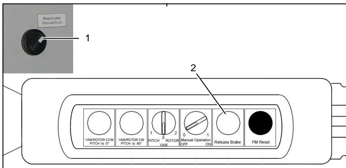
Abb. 21: Bedienelemente für manuellen Betrieb der Rotorbremse
