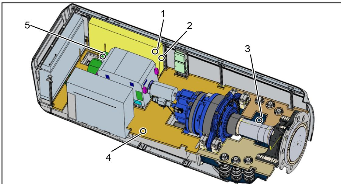
Abb. 14: Not-Halt-Schalter und Ausschalter MS im Maschinenhaus
