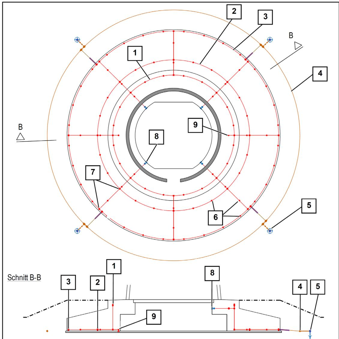
Abb. 2: Schema Einbruchmeldeanlage
