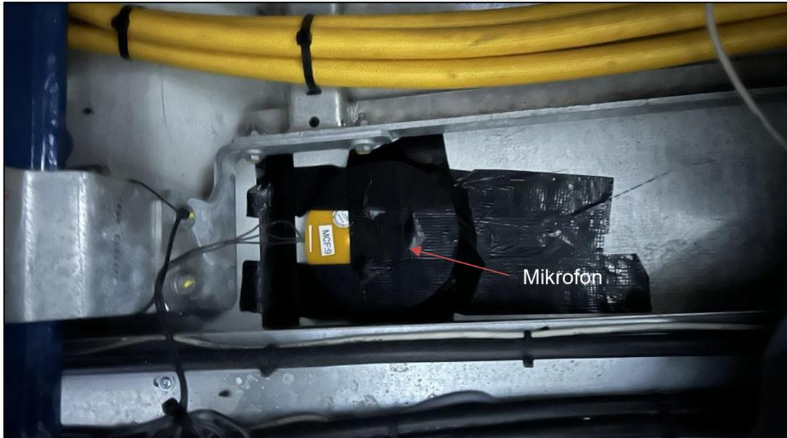
Abbildung 5: Aufbau des Scheibenmikrofons eines Gondelmonitorings im Boden einer Gondel.
