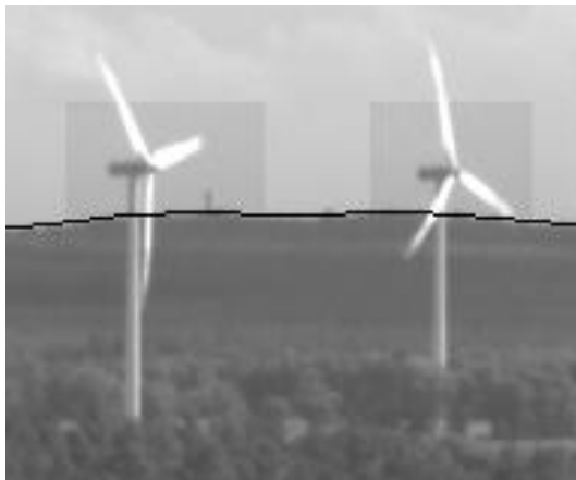
Abbildung 1: Automatisch generierte Ausschlussgebiete um Rotoren von WEA
