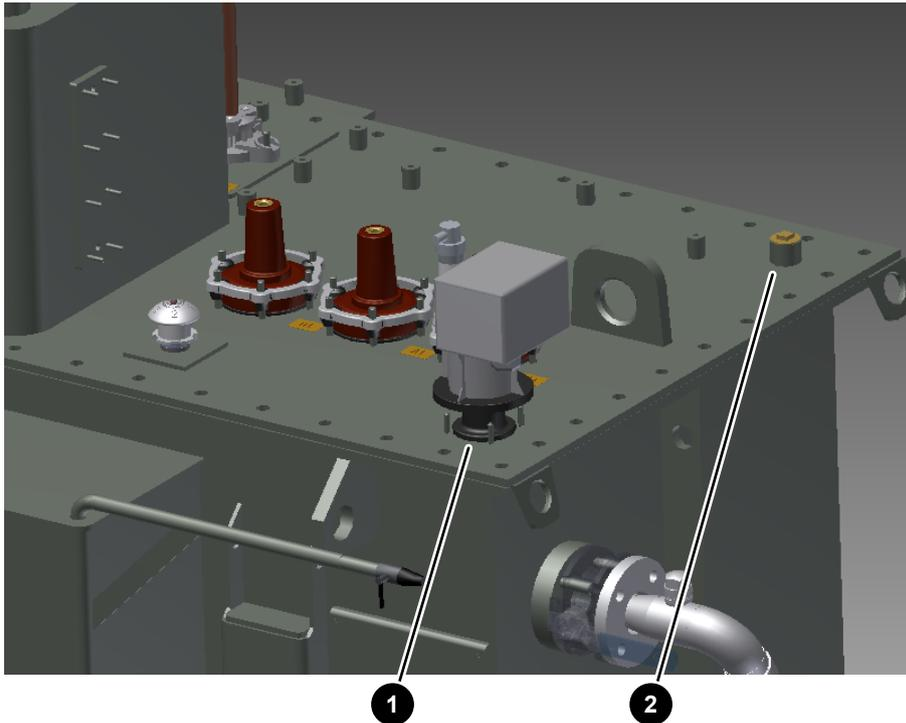
Abb. 2: Beispielhafte Ansicht der Transformatorschutzsensoren
