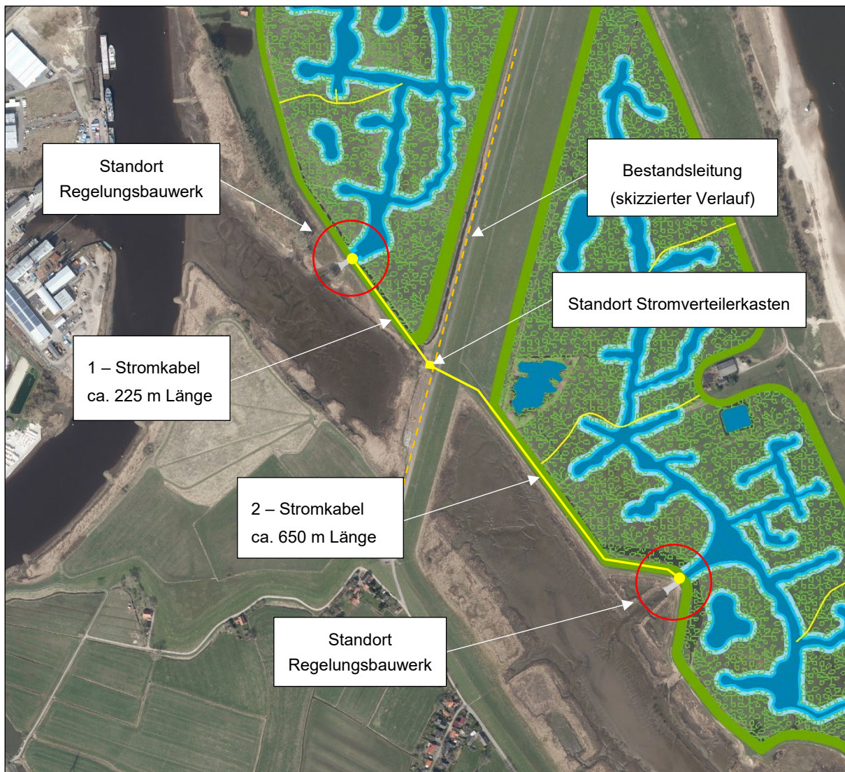
Abbildung 13: Standorte der Regelungsbauwerke und Verlauf der Stromkabel bis zum Stromverteilerkasten
