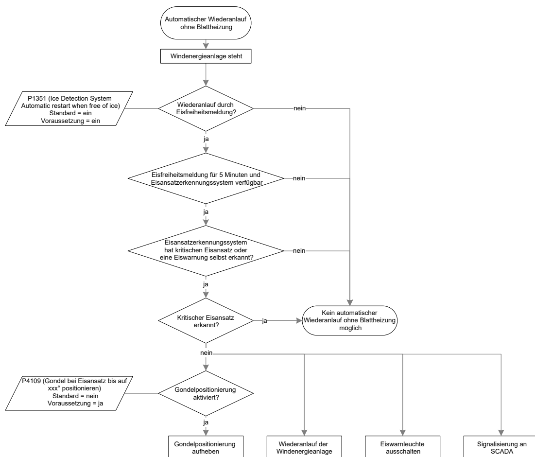
Abb. 8: Automatischer Wiederanlauf ohne Blattheizung
