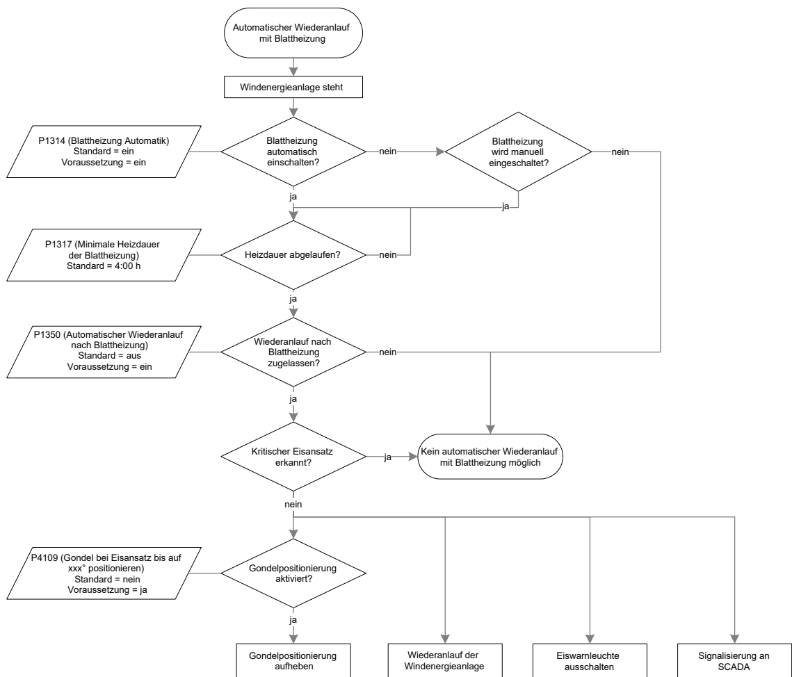
Abb. 3: Automatischer Wiederanlauf mit Blattheizung
