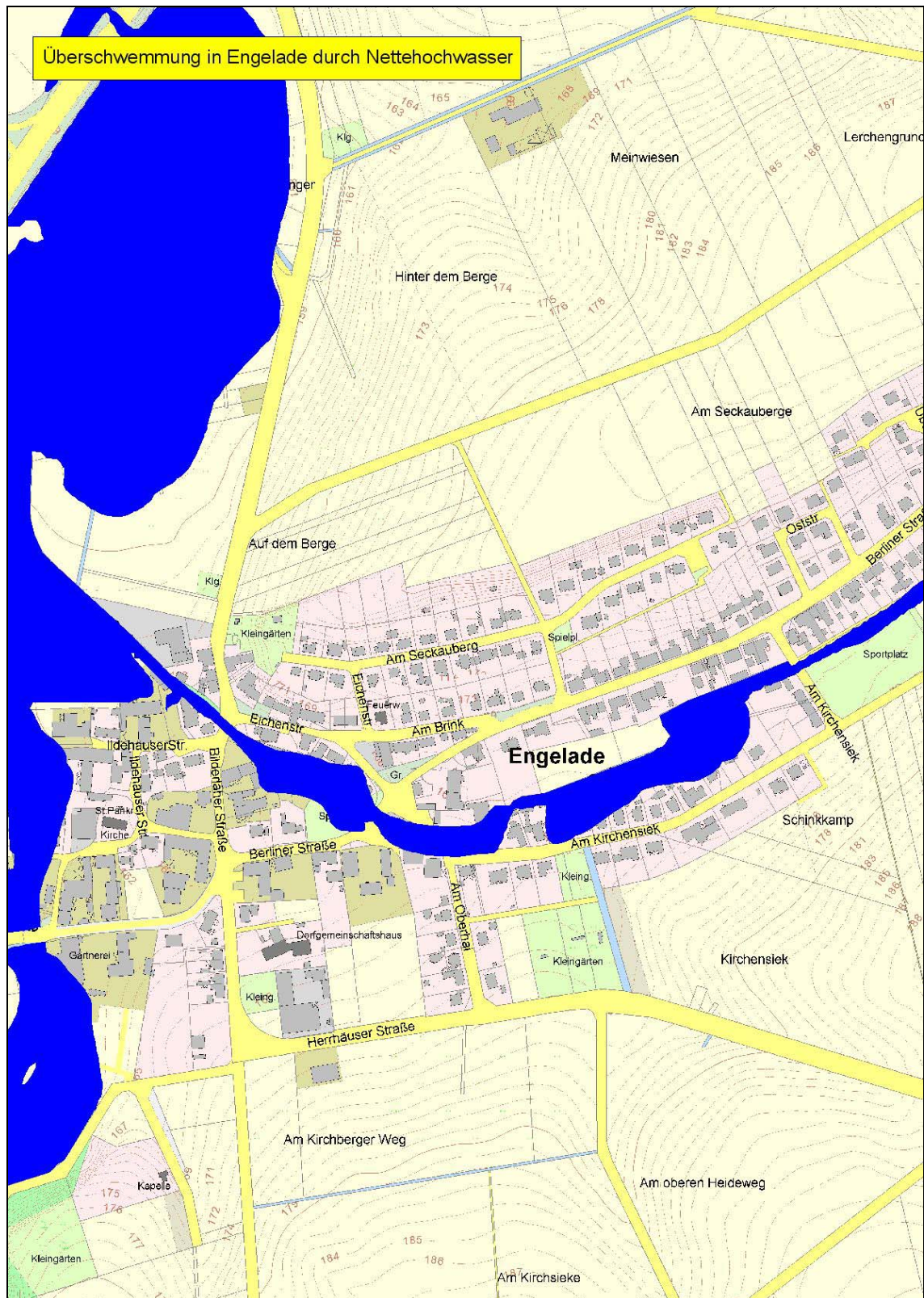
Abb. 7.9 Überschwemmungsfläche in Engelade durch Rückstau eines Nettehochwassers
