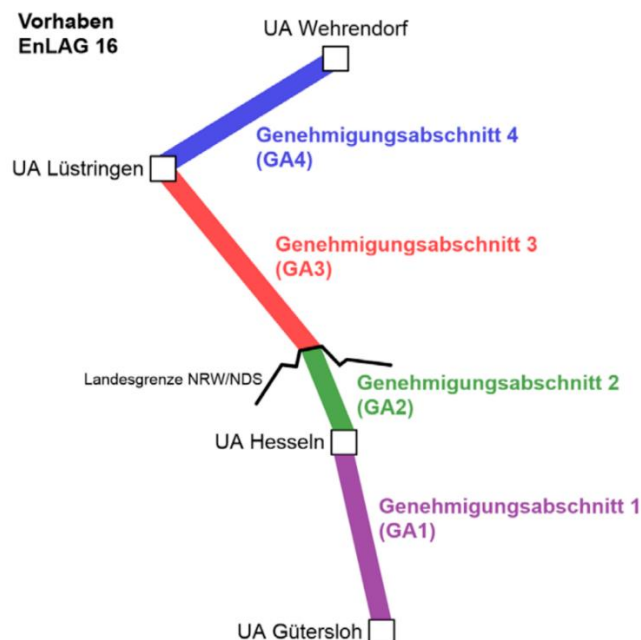
Abb. 1-1: Schematischer Verlauf des EnLAG-Vorhabens Nr. 16 mit den Genehmigungsabschnitten
