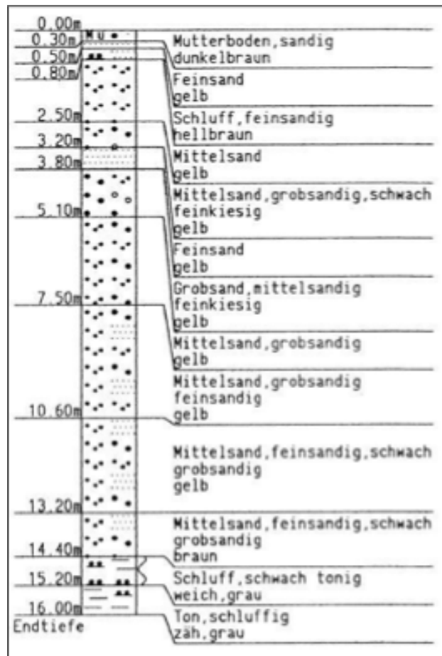
Abb. 10 Aufschlussbohrung B3 im Abbaubereich D2 vom 27.01.2000 11 (Beispielhaft für insgesamt 16 Bohrungen)
