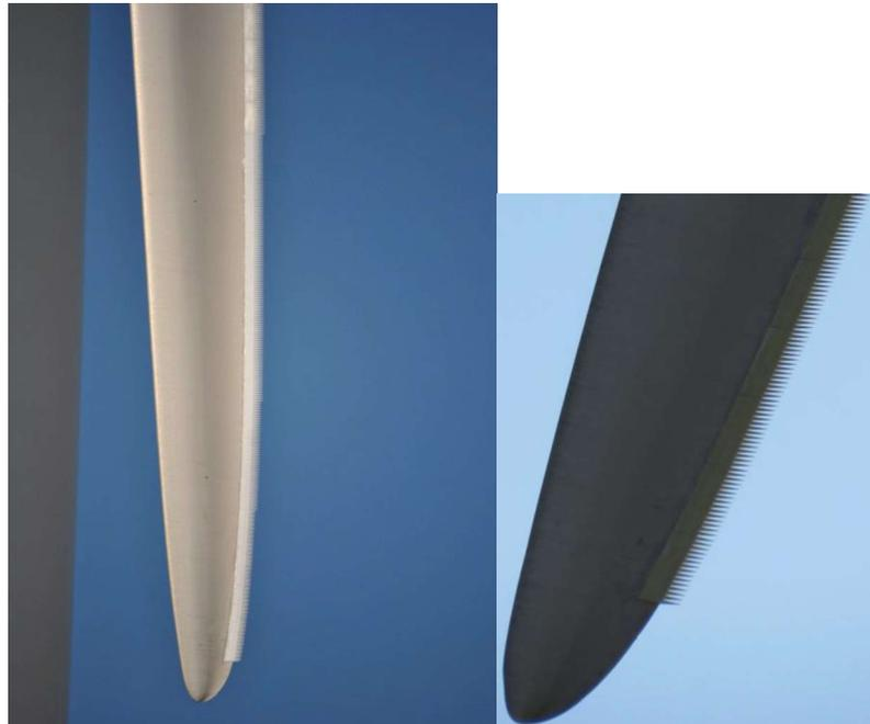
Abbildung1: Sägezahn-Hinterkante an Vestas-Windenergieanlagen
