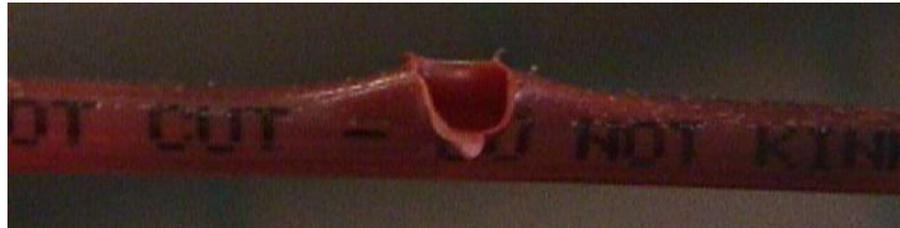
Abbildung 1: Die linearen Schläuche der pneumatischen Meldeanlage werden bei offenem Feuer oder Umgebungswärme aktiviert.
