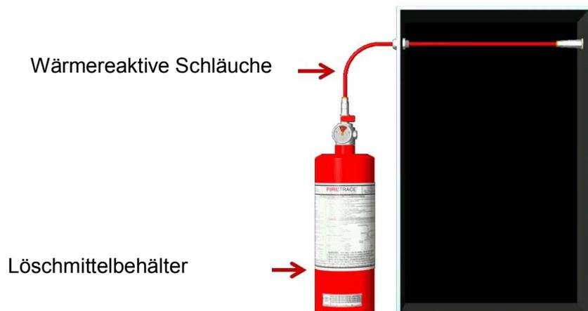
Abbildung 6-1-1: Direktes Löschesystem
