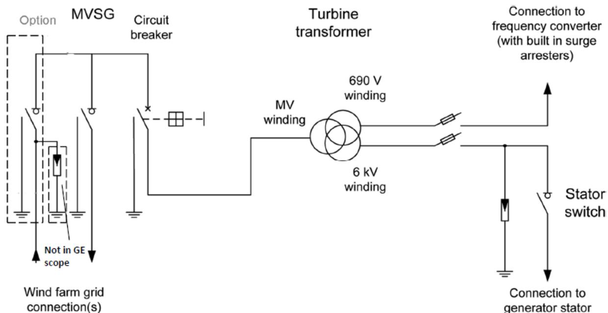
Abbildung 1: Überspannungsschutz des elektrischen Systems der WEA
