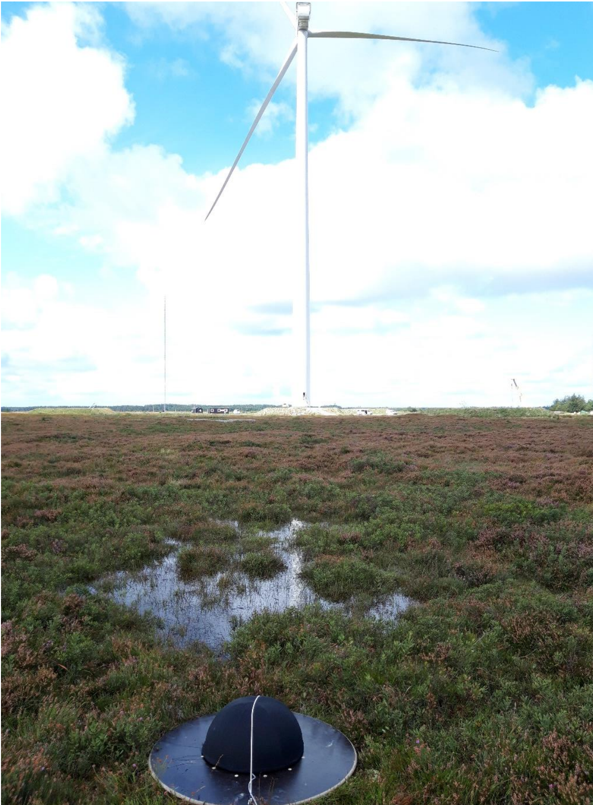
Foto 2: Foto der schallharten Platte mit Mikrofon unter dem Sekundärwindschirm
